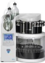
영문 장비명 : Accelerated Solvent Extraction System (ASE)
