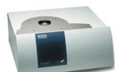
영문 장비명 : Differential Scanning Calorimeter
