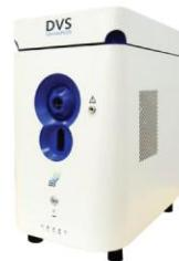
영문 장비명 : Dynamic Vapor Sorption Analyzer (DVS)
